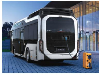
FCVバス「SORA」の大容量外部給電システム
