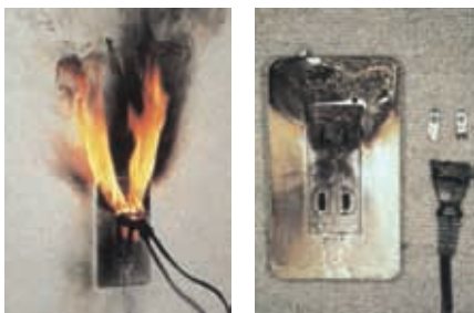
▲トラッキング現象により出火した電源プラグ
