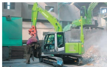
●電動式油圧建機の採用でCO<sub>2</sub>も削減
