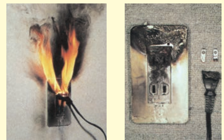
▲トラッキング現象により出火した電源プラグ
