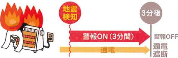
地震を検知すると警報が鳴り出します。その後、3分が経過すると主幹漏電ブレーカーを自動遮断し、警報が鳴り止みます。
